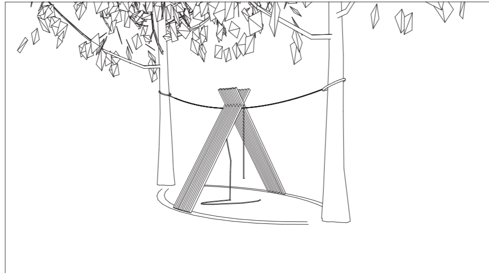
Présentation des tasseaux un à un en les positionnant sur l'implantation au sol et reposant sur la corde provisoire. Passage au fur et à mesure de la corde définitive dans les tasseaux prépercés à 3 mètres.
